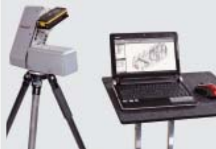
/ Bestückt mit Laserdistanzmessgerät sendet Flexijet die Objektkoordinaten direkt zum PC.
